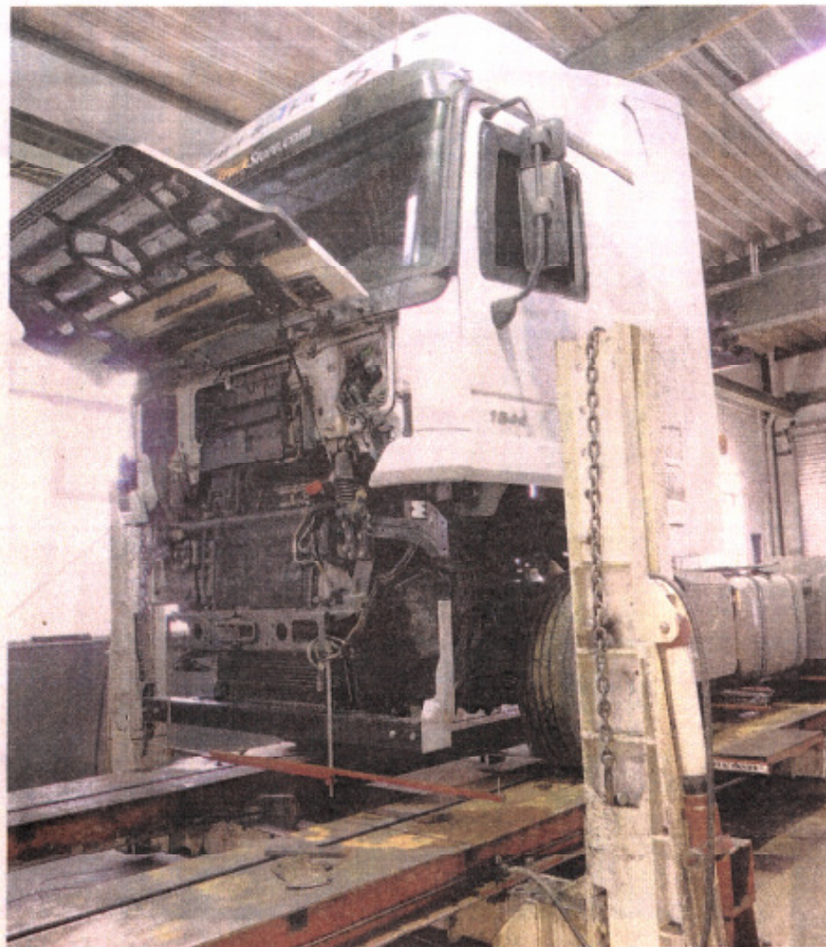
Schwere Geschütze: Im Rahmenrichtwerk werden verzogene Lkw mit Ketten wieder in Form gebracht.
