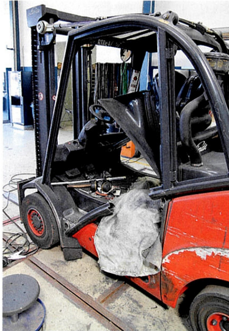
Die Kabinen umgestürzter Gabelstapler oder Schlepper können ebenfalls gerichtet werden.
